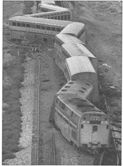
9 août 1997, Kingman, Arizona, États-Unis Déraillement d'un train après son passage sur un pont endommagé par la tempête : plus de 100 blessés. © AFP/John Gurzinski
