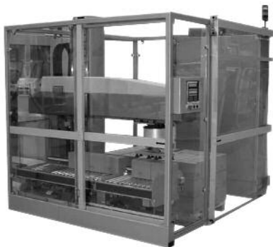
Palettiseur 4 axes (préhension/transfert) mis au point par Cernex (© Cernex)
