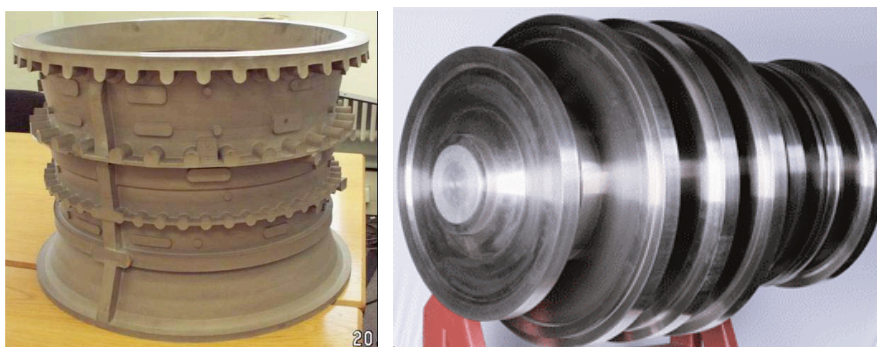
Figure 3 - Exemples de composants de turbomachines fabriqués par near net shape manufacturing
